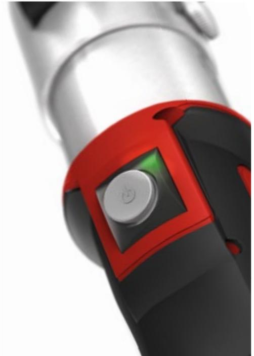
El protector de dedos, así como el perno de sujeción manual y el indicador de fallo implementado en el botón de inicio, garantizan la seguridad en el trabajo.
