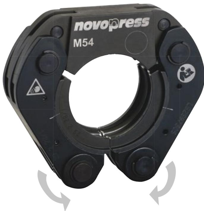
El principio “snap-on” garantiza que nuestras mordazas collar, tras su posicionamiento sobre el accesorio, queden automáticamente fijas mediante la fuerza de un resorte.
