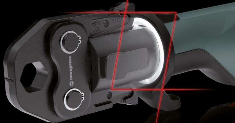
Der LED-Lichtring bringt mit 27 Leuchtdioden ein Vielfaches an Leuchtkraft. Das sorgt für bessere Sichtverhältnisse und mehr Sicherheit bei Ihrer Arbeit. Außerdem zeigt er durch den Farbiring an, ob die korrekte Presskraft aufgebaut wurde. Leuchtstärke und Dauer lassen sich individuell per App einstellen.
